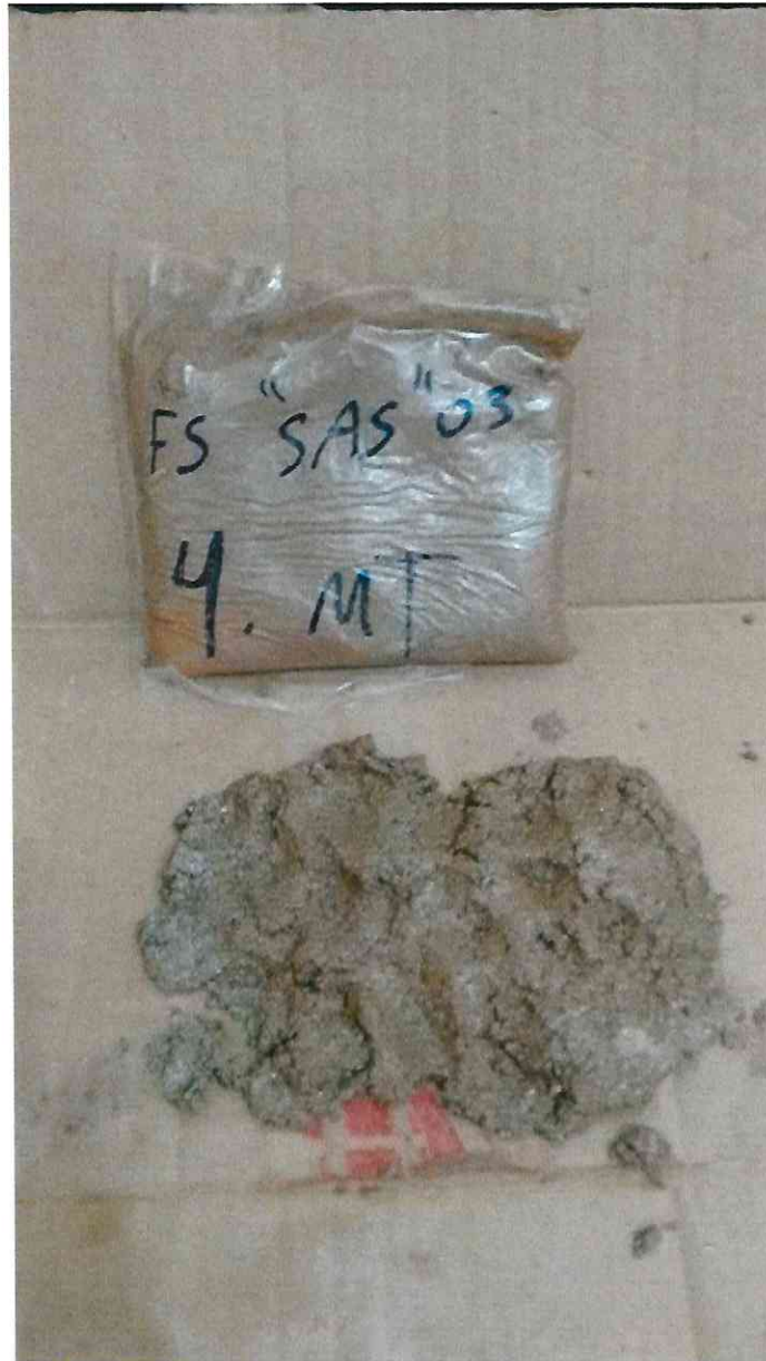
Figura 11.4 – Notar a presença de água na amostra de solo.
