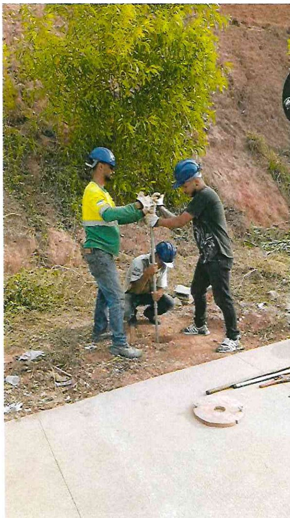
Figura 08 – Início da sondagem utilizando o trado concha até 1 m de profundidade. Fonte: Autoral.
