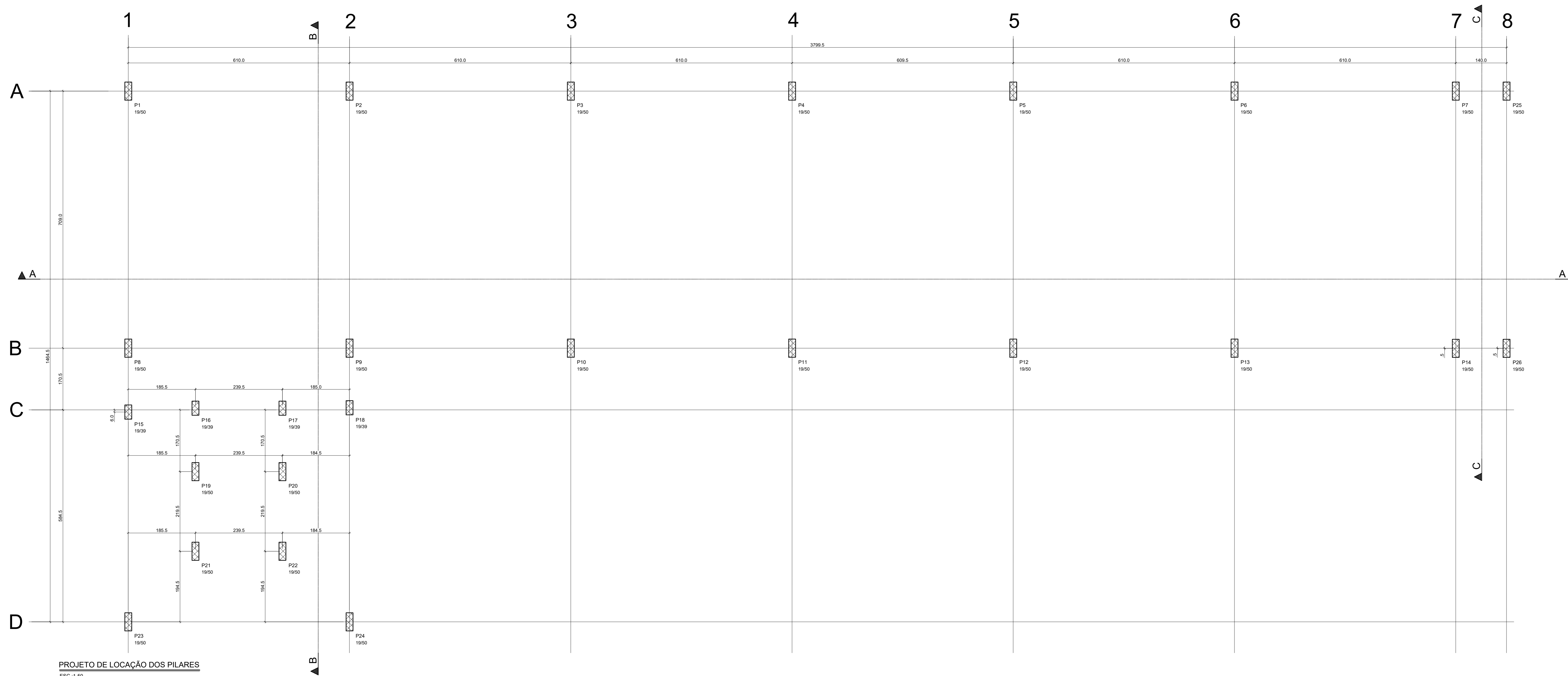
PROJETO DE LOCAÇÃO DOS PILARES ESC. 1:50
