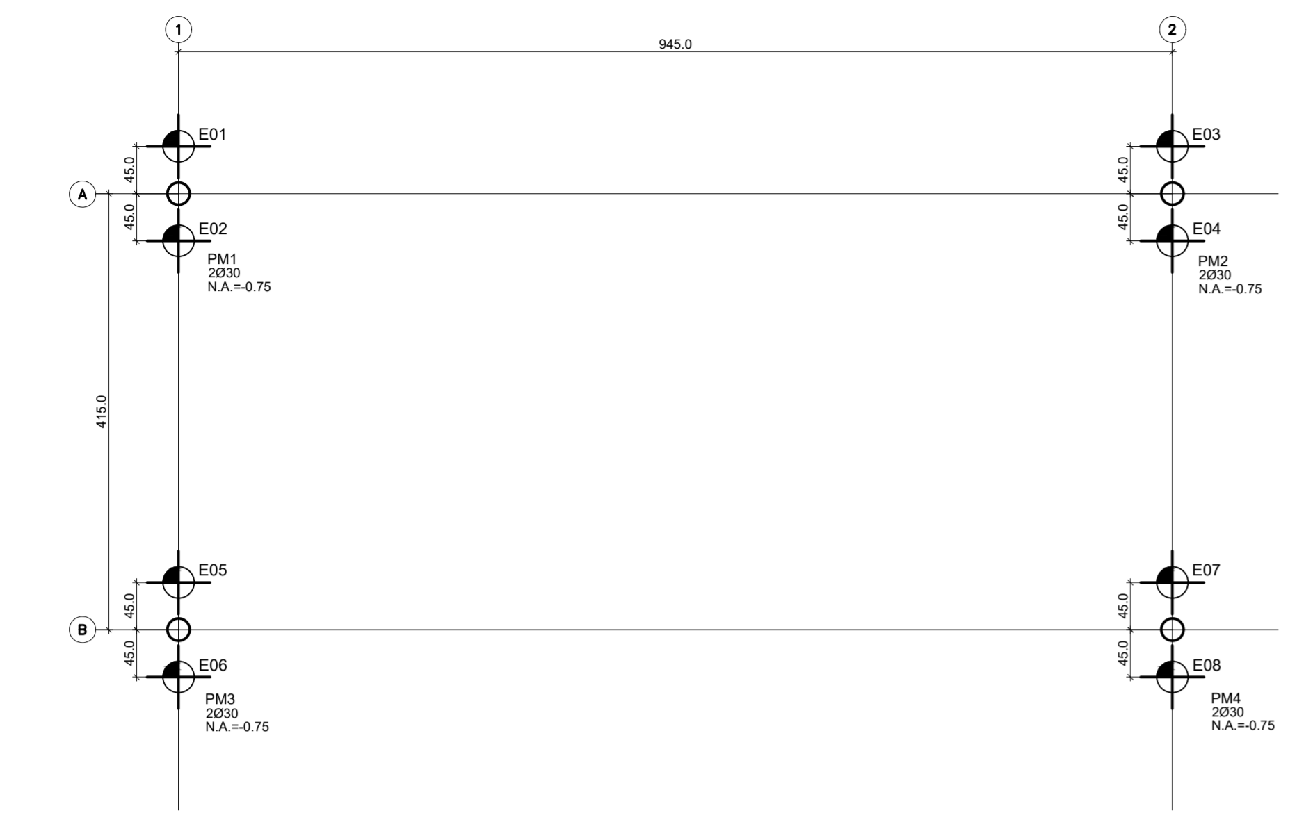
PROJETO DE LOCAÇÃO DAS ESTACAS ESCALA 1:50
