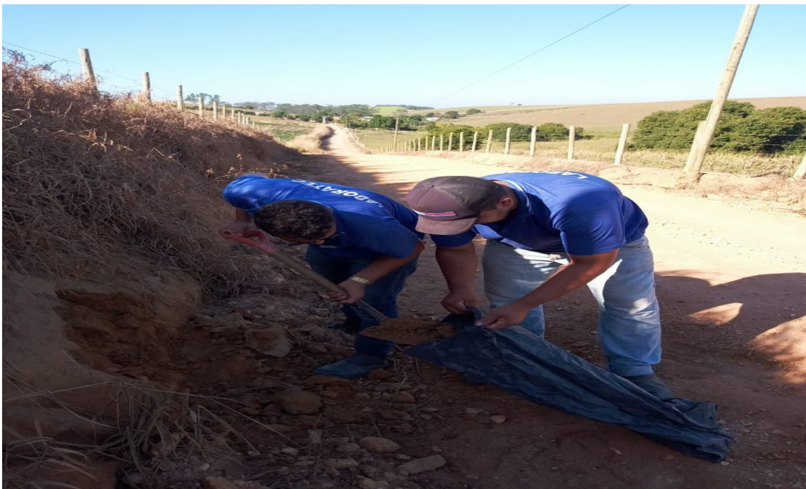
Coleta de amostra do sub leito, estaca 90 a 95
