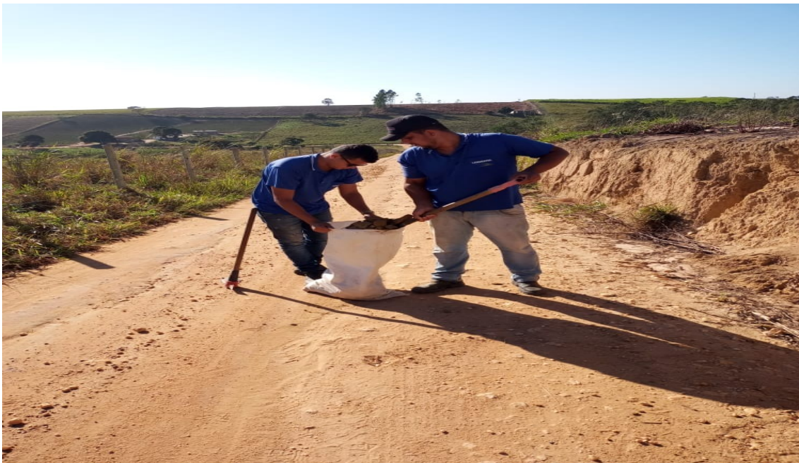
Coleta de amostra do sub leito, estaca 114 a 118
