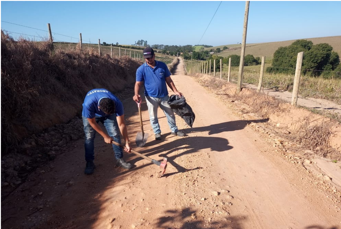
Coleta de amostra do sub leito, estaca 187 a 195
