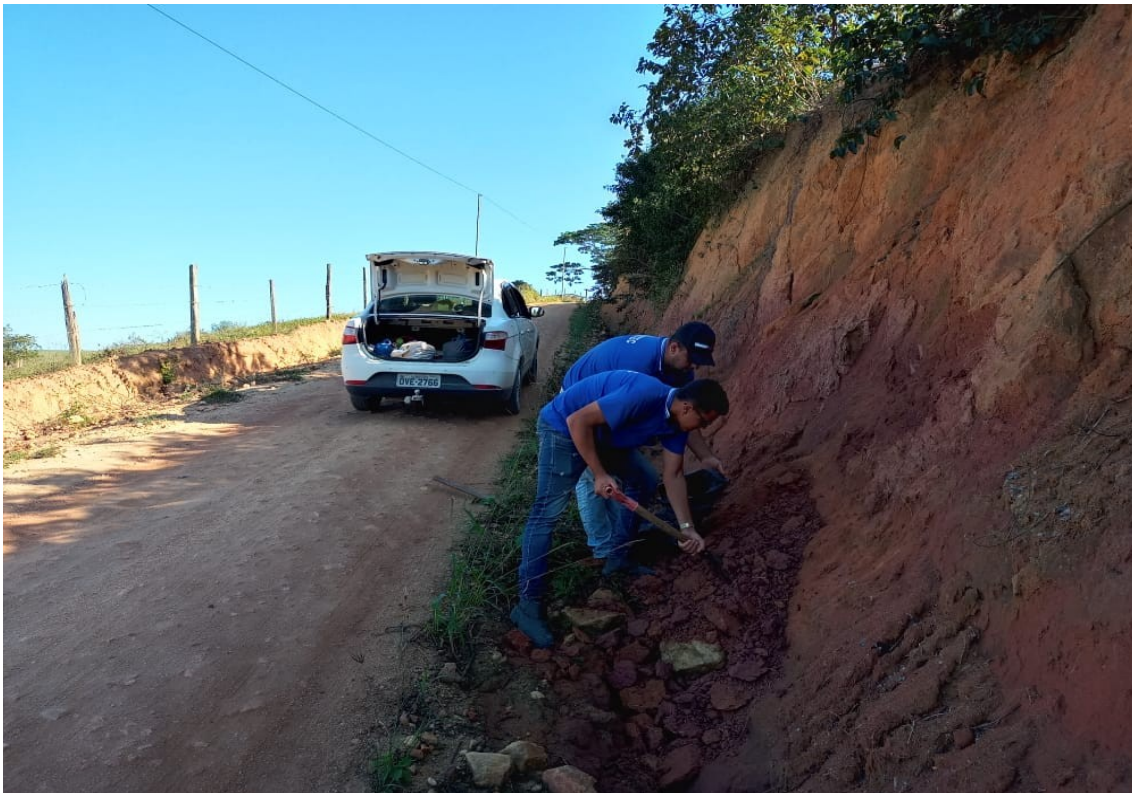
Coleta de amostra do corte, estaca 239 a 243
