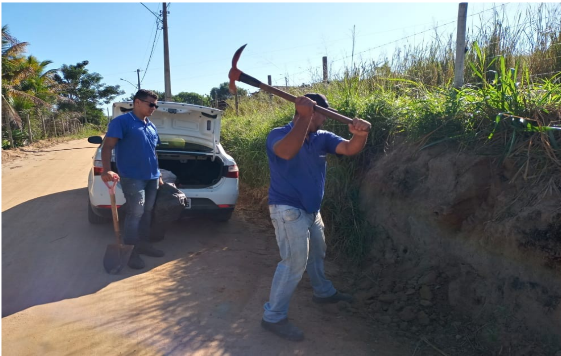
Coleta de amostra do sub leito, estaca 165 a 176
