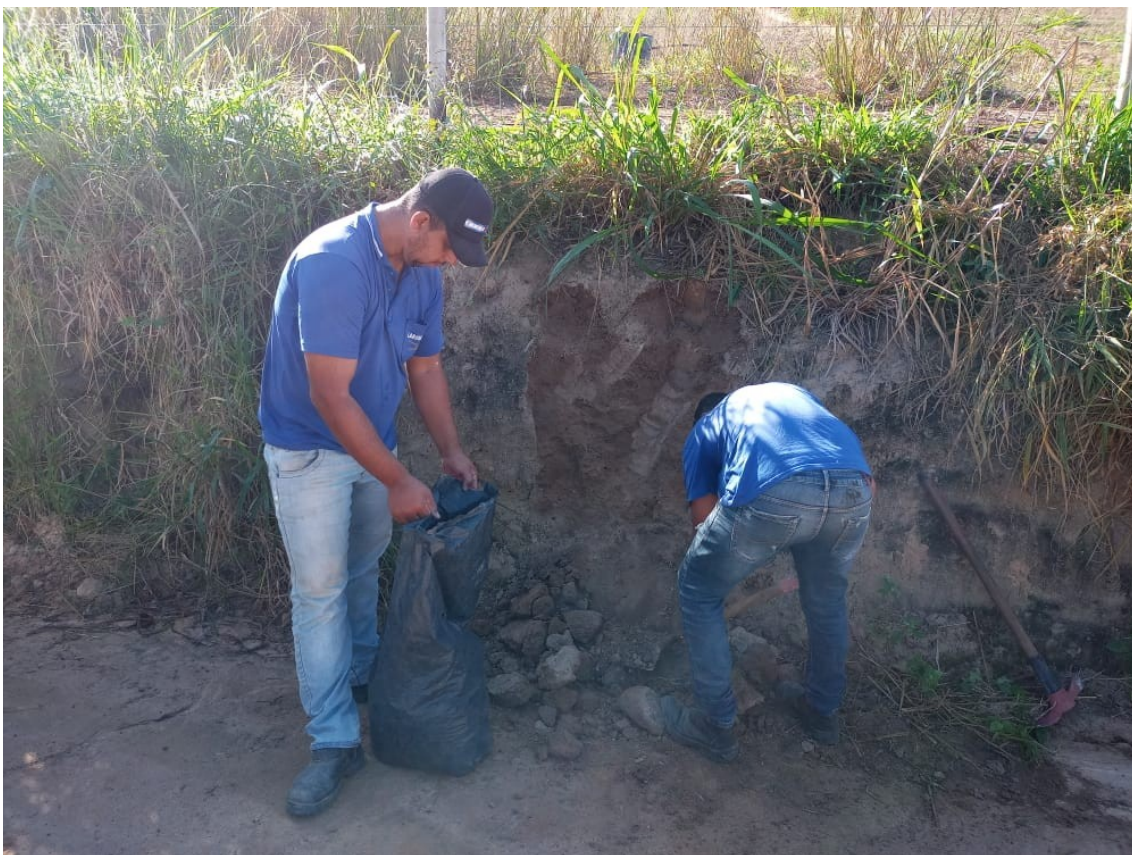
Coleta de amostra do sub leito, estaca 165 a 176
