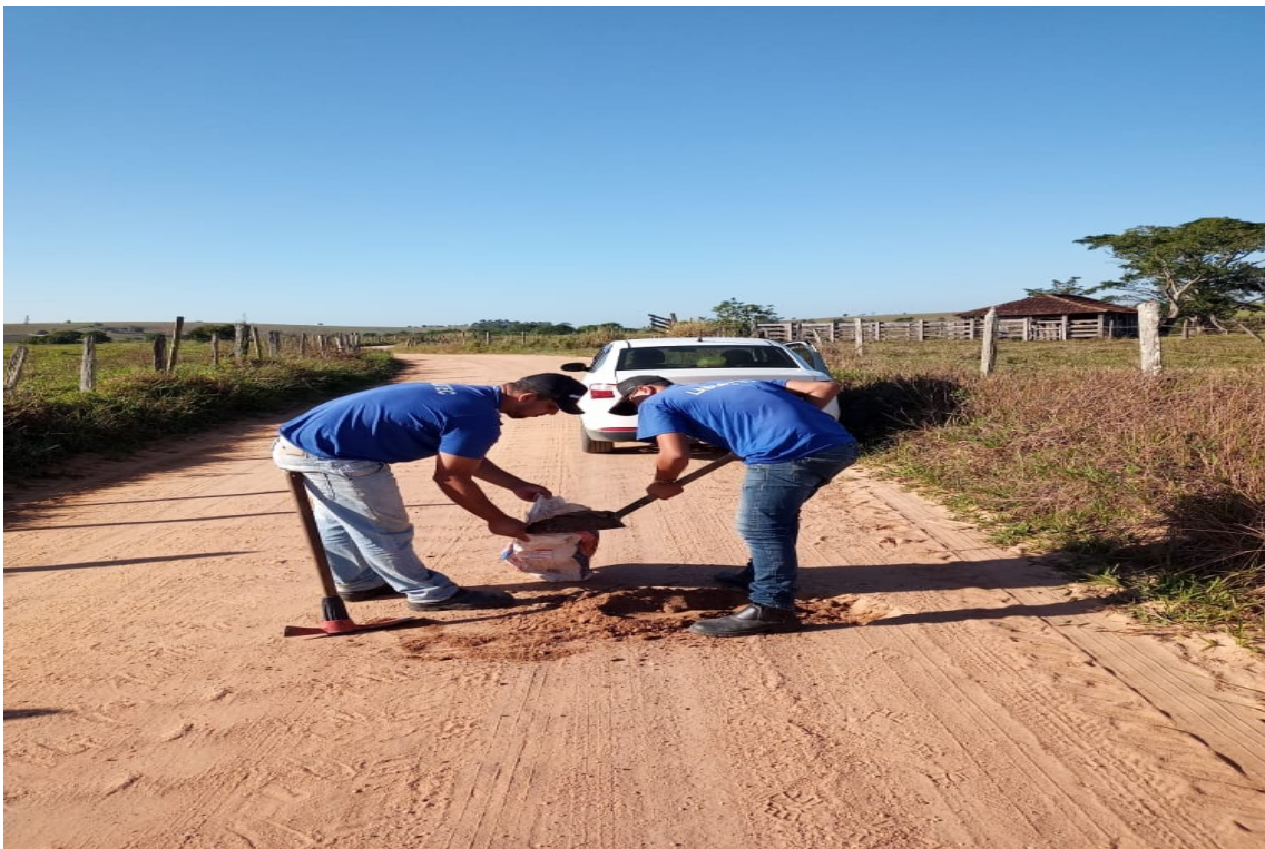
Coleta de amostra do sub leito, estaca 01 a 15
