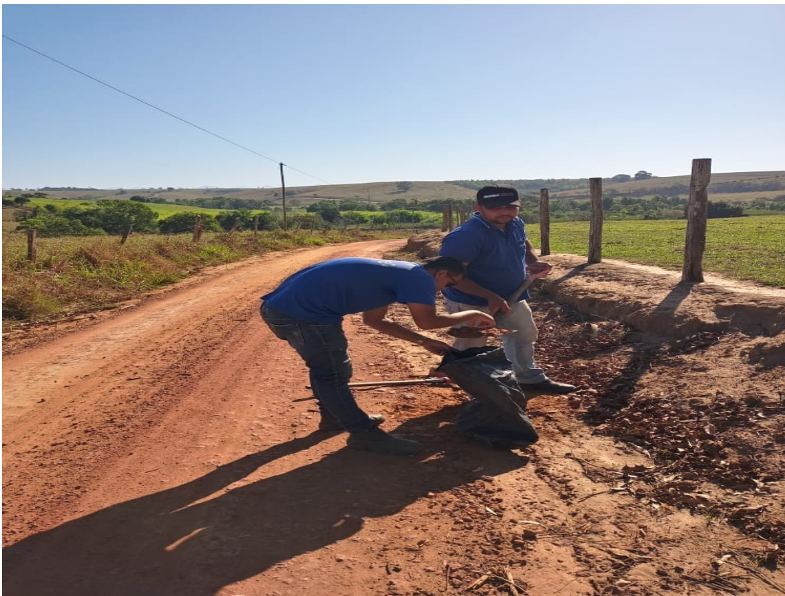
Coleta de amostra do sub leito, estacas 312 a 321
