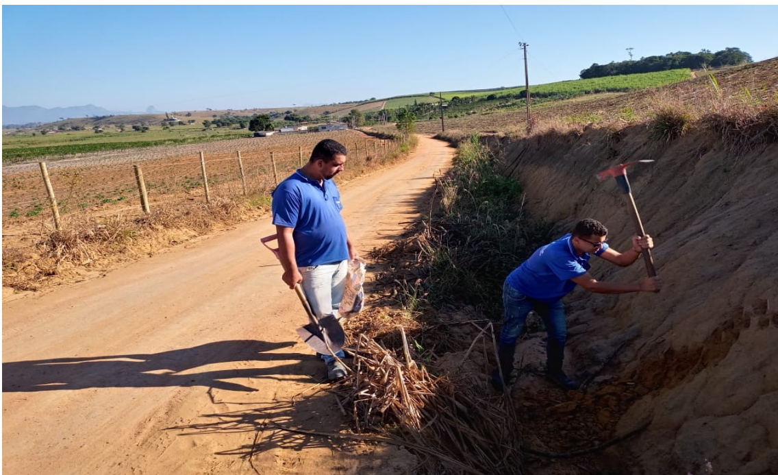
Coleta de amostra do sub leito, estaca 73 a 76
