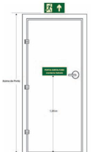
Figura 1 - Sinalização de porta corta-fogo (vista da escada)
