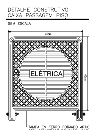
DETALHE - CAIXAS DE PASSAGEM DE PISO EM CONCRETO E COM TAMPA METÁLICA SEM ESCALA - DIMENSÕES EM MILÍMETROS
