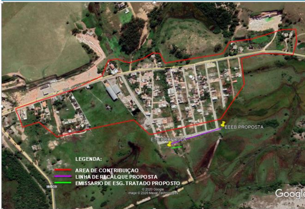
Figura 1 – Vista da localidade de Campo Novo com o SES proposto. Imagem Google.
