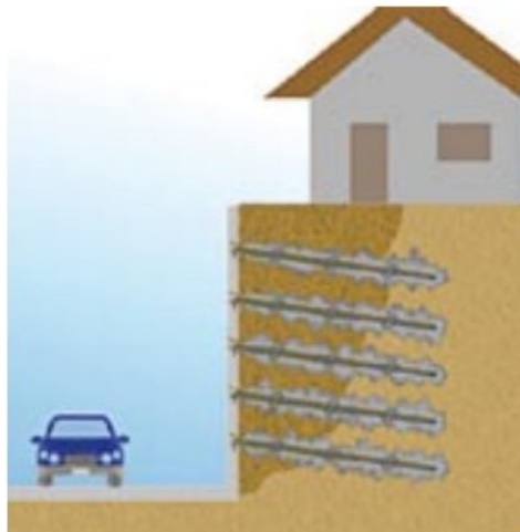
Figura 2 - Emprego de solo grampeado em taludes acidentados
