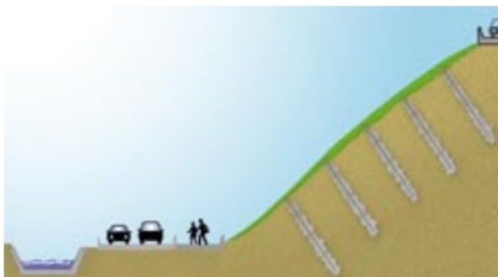
Figura 1 - Emprego de solo grampeado em taludes instáveis
