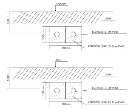
DETALHE - 14: ENVELOPAMENTO DOS ELETRODUTOS SEM ESCALA
