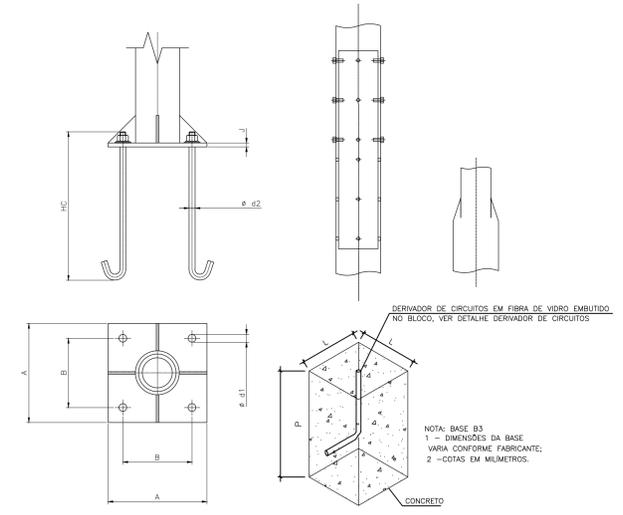
DERIVADOR DE CIRCUITOS EM FIBRA DE VIDRO EMBUTIDO NO BLOCO. VER DETALHE DERIVADOR DE CIRCUITOS
