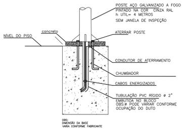
POSTE AÇO GALVANIZADO A FOGO PINTADO NA COR CINZA RAL "n" UTIL = 4 METROS SEM JANELA DE INSPEÇÃO
