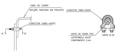
DETALHE - 17: INSTALAÇÃO DA HASTE DE TERRA SEM ESCALA
